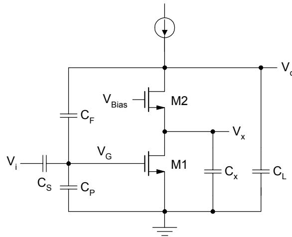
$$v_o : s(C_L + C_F)v_o - sC_Fv_g - g_{m2}v_x + i_{n2} = 0$$
