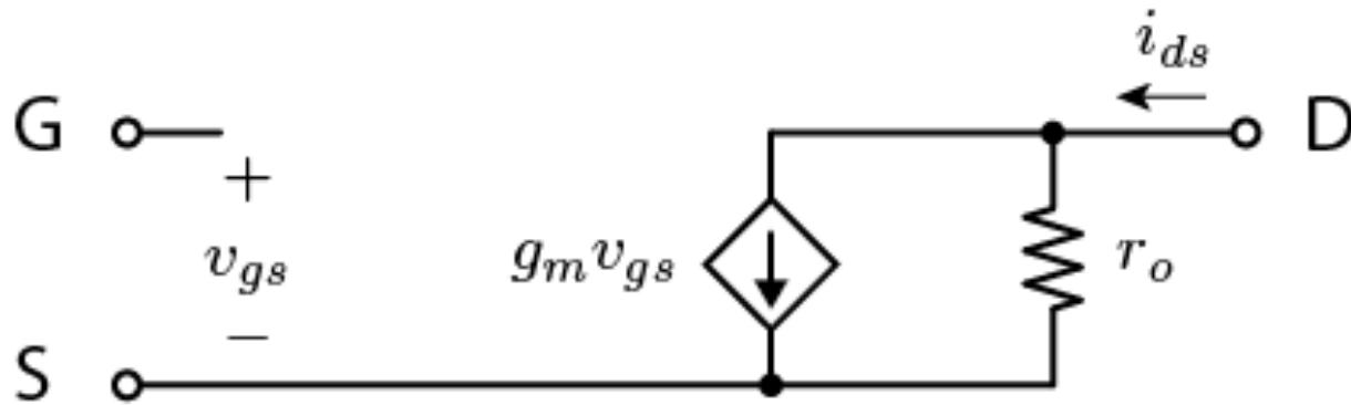
$$i_{ds} = g_m v_{gs} + \frac{1}{r_o} v_{ds}$$
