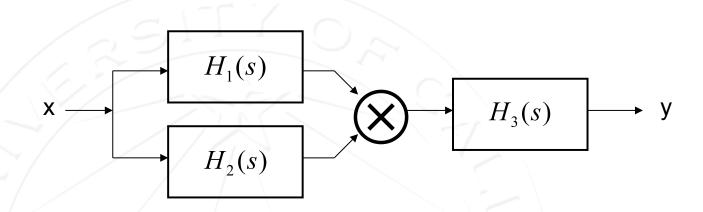
$$F(s_1,s_2) = H_1(s_1)H_2(s_2)H_3(s_1+s_2)$$
